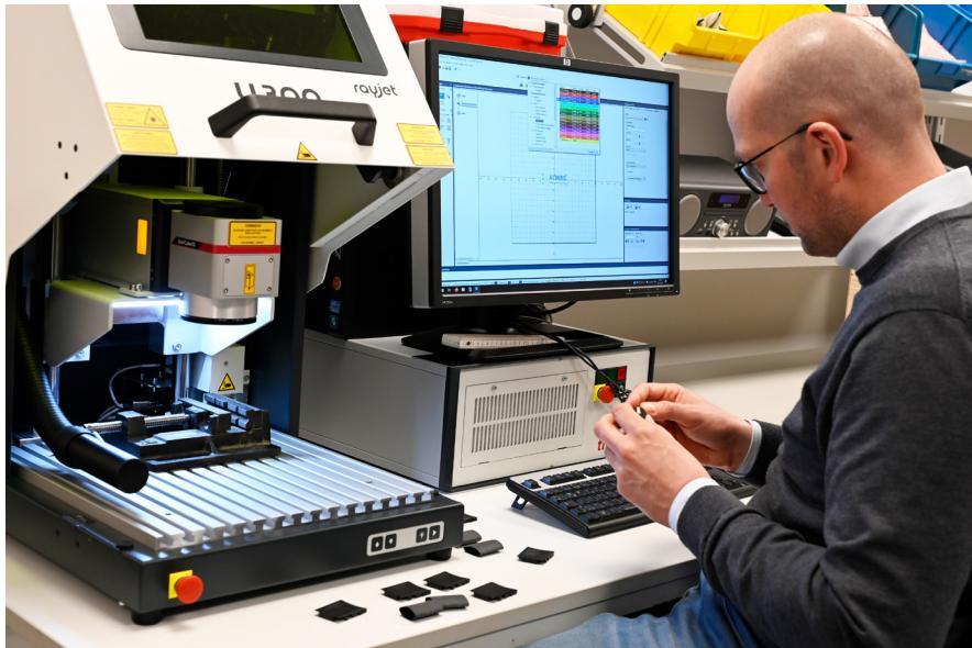
*Martin Alders gibt am Rechner die gewünschten Parameter für die Kennzeichnung eines Bauteils ein. Binnen weniger Sekunden wird die Maschine (links) die Signatur nun einarbeiten.*
